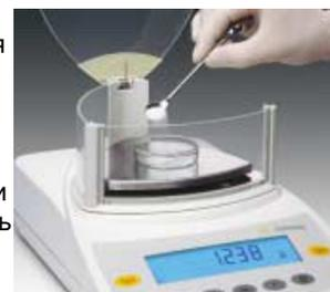
Треугольная ветрозащитная витрина моделей с дискретностью отсчёта 1 мг обеспечивает возможность гибкой работы на этих приборах. Вынимающиеся по отдельности стекла ветрозащитной витрины (слева, справа и спереди) обеспечивают очень хороший доступ к чашке весов, как для правой, так и для левой.
