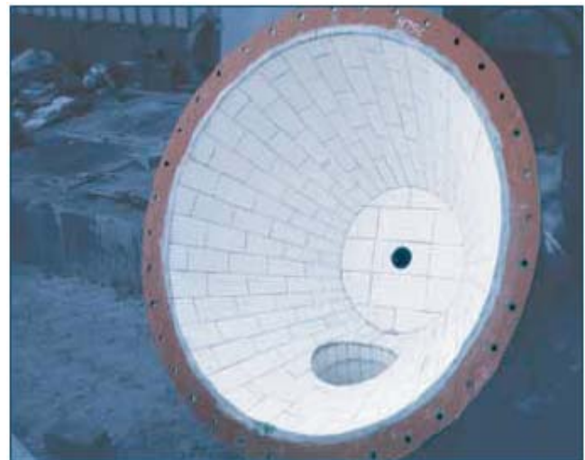
Лоток миксера для разгрузки агрессивных суспензий
