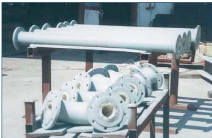
Сегменты трубы для ТЭС, перед сборкой. Срок эксплуатации: базальтовое литьё < 1 года, керамика > 5 лет
