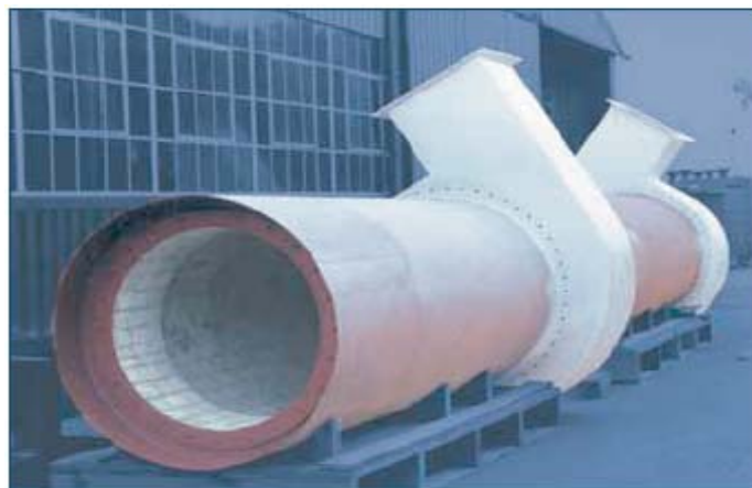
Труба пневмоконвейера для ТЭС
