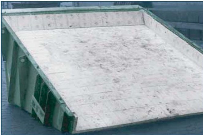
Вибропитатель (металлургический завод) шестикратный период эксплуатации по сравнению с твёрдой сталью
