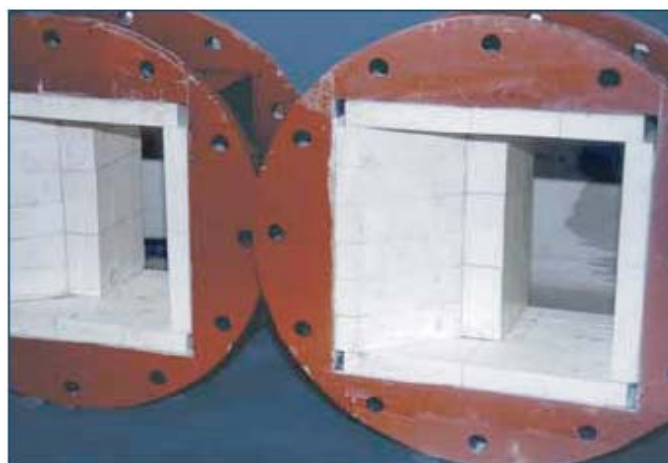
Перегородка для уменьшения скорости потока и деагломерации брызг коррозионной окиси
