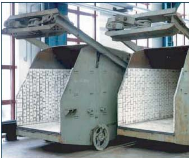
Скиповые тележки для загрузки доменной печи. Высокое количество ударного износа. Требуемый период эксплуатации > 5 лет завершен
