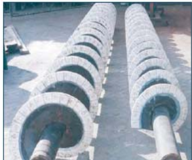
Защита кромки скребкового конвейера для транспортировки абразивной гидросмеси
